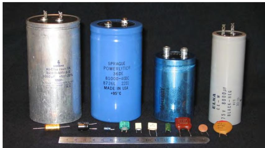
Figura 2-2. Diferentes tipos de condensadores.
