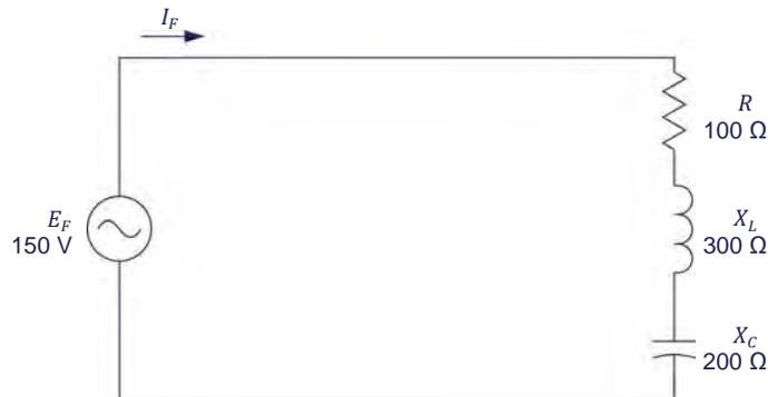
Figura 4-4. Circuito ca serie compuesto por un resistor, un inductor y un condensador.
