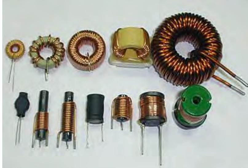
Figura 2-1. Diferentes tipos de inductores.
